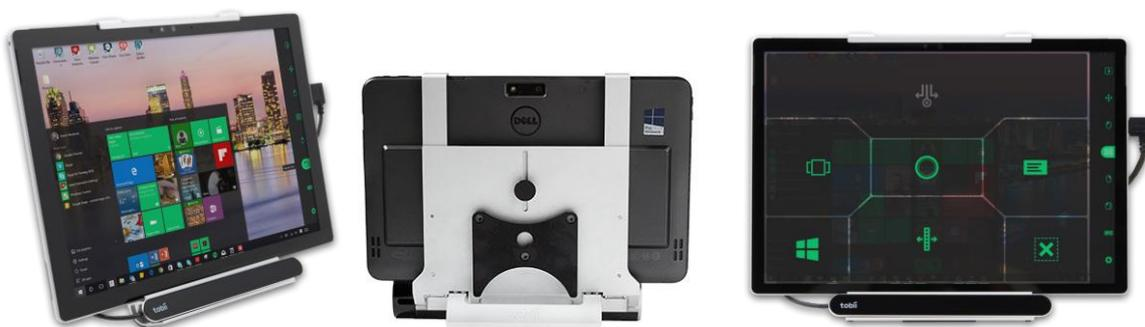
**Tobii Eye Mobile** est une commande oculaire s'adaptant à une Tablette, dédiée aux personnes ne pouvant pas utiliser l'accès tactile. Le contrôle se fait alors avec les yeux de manière instantanée et avec haute précision.
